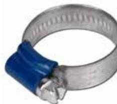
Fascette TIPO ABA in acciaio al carbonio, nastro e vite zincati a lucido e cromatati, castelletto stampato e verniciato colore blu. La costruzione della fascetta e l'alta resistenza del materiale garantiscono un serraggio ottimale. Nastro con bordo arrotondato che elimina il rischio di danneggiare il tubo, vite a testa esagonale 7 mm.
