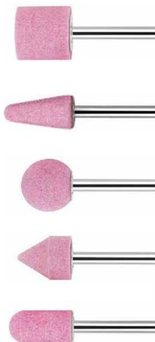
Le molette di smeriglio rosa realizzate in corindone rosa e legante ceramico vetrificato che ne garantisce una buona durata e altrettanta capacità. Adatte ad un impiego universale su tutti i tipi di acciaio e ghisa, prodotte con elevati standard qualitativi in grado di assicurare elevate capacità di asportazione e un'ottima qualità della superficie lavorata. Disponibili in varie forme adatte a lavorazioni di sbavatura su metalliferosi e non ferrosi o su diversi tipi di leghe non ferrose.
