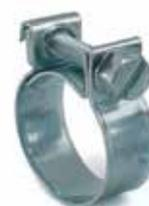
Le fascette stringi tubo minic lamp hanno un nastro a bordi rialzati per non danneggiare il tubo. La linguetta inferiore è munita di rinforzo. Pratica testa esagonale della vite, dotata di intaglio e adatta per l'utilizzo del cacciavite flessibile, particolarmente indicata per tubi di piccolo diametro e di spessore ridotto.
