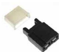
I fusibili ripristinabili UNI sono in grado di garantirti il massimo controllo grazie all'interruttore termico automatico unipolare che sostituisce la comune area di fusione ad asticella dei fusibili più diffuso. In caso di alte correnti in ingresso, l'interruttore si "stacca" proteggendo il circuito. Quando il pericolo è passato, l'interruttore termico ritorna nella sua posizione iniziale, facendo riprendere il corretto funzionamento del circuito elettrico.
